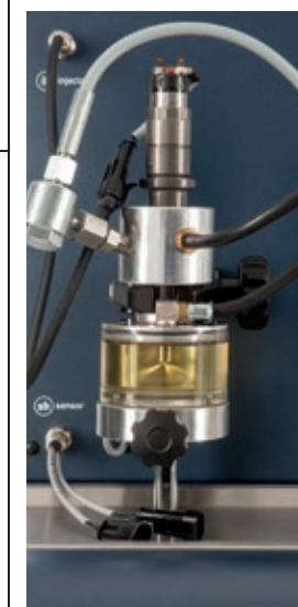
PRÜFSTÄNDE FÜR CR- UND GDI-INJEKTOREN, MIT PRÜFZERTIFIKAT
